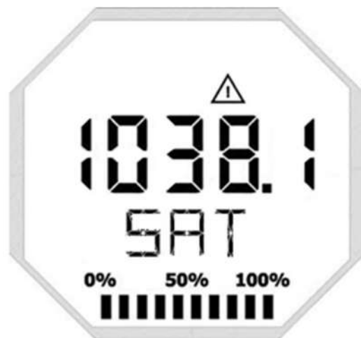
Figura 3.14 – Indicación de saturación de la medición del VPT10-H.
