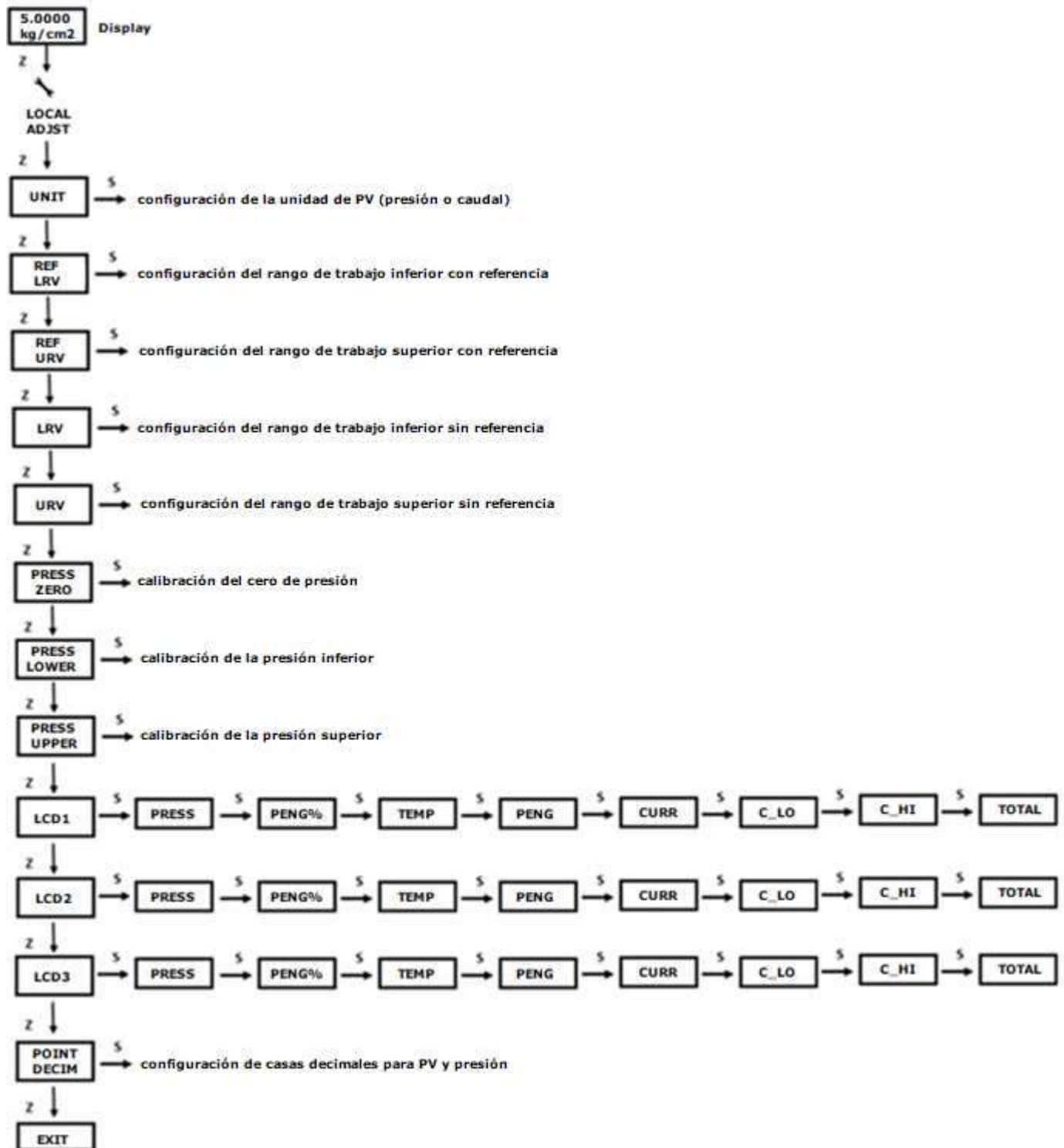
Figura 3.8 – Árbol de programación del ajuste local del VPT10-H.
